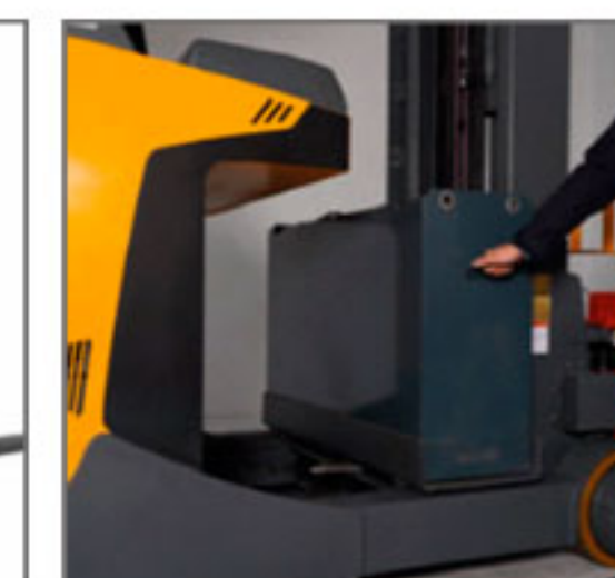
• La batería puede extraerse con el mástil; la estructura lateral facilita su mantenimiento o sustitución.
