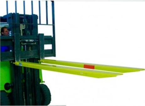
Augmentez les performances et la sécurité de votre camion en allongeant les clous. Pour largeur 125mm. Capacité de charge de 85% de la charge du camion.
