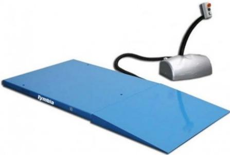
Mesa elevadora eléctrica de tijera con capacidad de carga hasta 1000kg extraplana con rampa, y una altura de elevación de 840mm. Las dimensiones de la plataforma son 1450x1140mm. Altura regulable mediante mando de control para conseguir mayor eficiencia y comodidad para trabajar.
