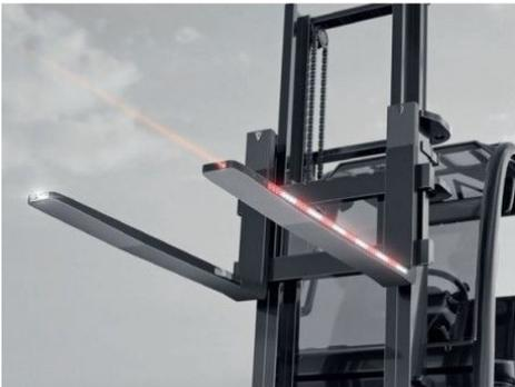
Horquillas con láser incorporado en la punta de la horquilla. El láser proyecta una línea recta marcando el lugar a donde se situarán las horquillas. Resulta de gran ayuda cuando la carga impide la correcta visión por parte del operario. Una seguridad total contra accidentes y colisiones.
