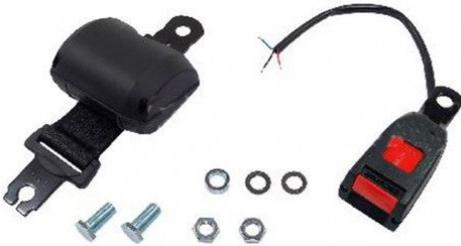
Cinturón de seguridad para asientos de carretilla. ALR (retractor de bloqueo automático). Hebilla de liberación doble en correa con anclaje 22cm. Longitud de la correa (negra o naranja): 128cm. Aprobación ECE R16, DIR 77/541, SAE JR86 & FMVSS 320.
