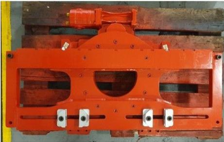
Implemento reacondicionado, volteador FEM2. Con una capacidad de carga de 2000kg y rotación de 360º.
