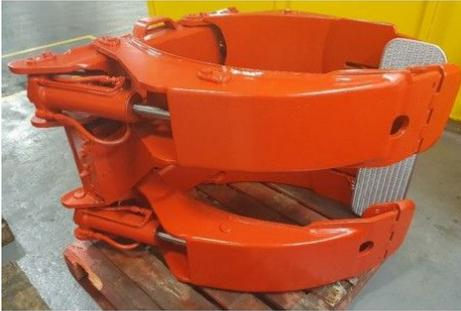
Implemento reacondicionado, pinza para rollos de papel, FEM2 y FEM3. Con una capacidad de carga de 2100kg, rango apertura 260-1520mm y una rotación de 180°.
