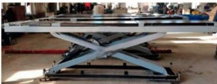
Elevador pantógrafo de doble tijera con una capacidad de 3500kg, 220 monofásica.
