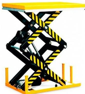
Mesa elevadora eléctrica de doble tijera, con capacidad de carga de 500kg y una altura de elevación máxima de 1780mm. Las medidas de la plataforma son 1300x820mm. La altura se regula mediante mando de control, garantizando una mayor comodidad y seguridad, con elevación y descenso suaves. Estructura de acero, equipada con bastidor de seguridad.
