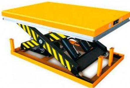
Mesa elevadora eléctrica de tijera simple, con una capacidad de carga de 2000kg y una altura de elevación hasta 1050mm. Las medidas de la plataforma son 2000x1200mm. La altura se regula mediante mando de control, garantizando una mayor comodidad y seguridad. Elevación y descenso suaves. Estructura de acero con barra de seguridad. Muy resistente.
