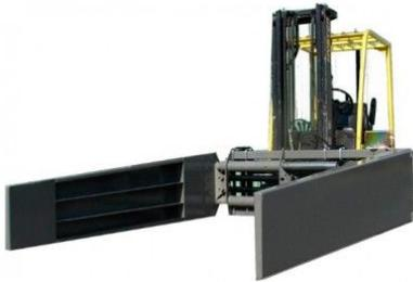
Pinza multifunción para realizar cargas con cajas llenas, cajas vacías, o para paletizar varios palets juntos. Acople sobre tablero FEM2/FEM3. Disponibles 3 versiones. Consúltenos.
