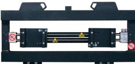
Posicionador de horquillas para carretilla elevadora, sin desplazador lateral, con una capacidad de carga hasta 5000kg (FEM3), y ancho del tablero de 1150mm.
