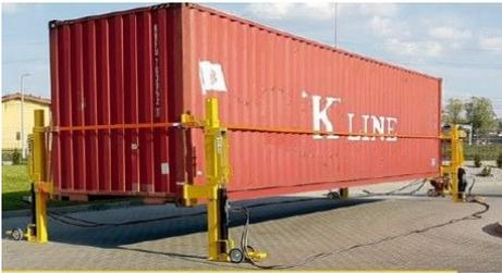
Sistema hidráulico de elevación de contenedores hasta 40" y 32 toneladas compuesto por 4 patas elevadoras hidráulicas a 1,4 metros de elevación (de fabricación especial hasta 1,8 metros), cuenta con un motor hidráulico eléctrico, cintas estabilizadoras y mangueras hidráulicas.
