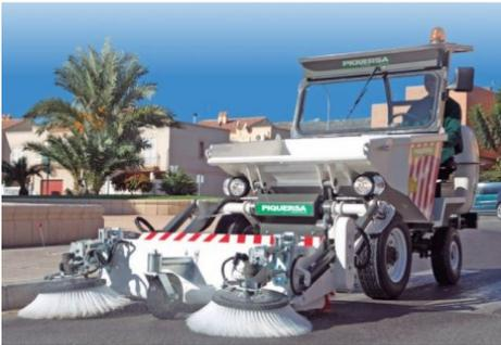
Tracción simple, motor Kohler de 15,5 CV.. Diesel, dos cilindros. Refrigerado por agua descarga hidráulica frontal. Dirección hidráulica, frenos hidráulicos...
