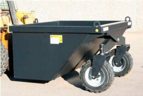
Dumper autocargable para minicargadoras. Ideal para acarreo e todo tipo de materiales en distancias elevadas. Capacidad de 1740lts a ras, eje delantero flotante, ruedas neumáticas y acoplamiento para minicargadora portante.
