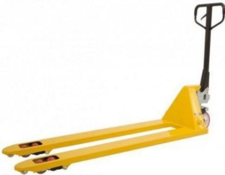
Transpaleta manual semi larga, con una capacidad de carga de 2000kg y unas dimensiones de 1500x540mm. Con rueda de timón y rodillos de poliuretano.
