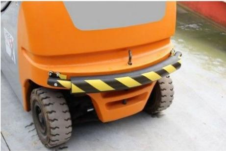
Los protectores para carretillas elevadoras proporcionan una mayor seguridad, funcionando como paragolpes y de este modo absorbiendo el impacto. Fáciles de instalar mediante imanes.
