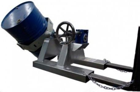
Implemento para carretillas para transportar, voltear y vaciar bidones de hasta 200 L con capacidad de carga hasta 360 Kg. Equipado con maneta y cadena de sujeción. Volteo lateral de 360º mediante manivela o cadena. Acople fácil para bidones metalicos mediante pinza con agarre de nylon. Posibilidad de adaptar para bidones de plástico.
