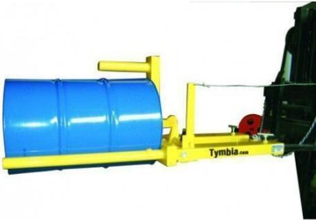
Implemento para carretillas para transportar y voltear bidones de hasta 200 L con capacidad de carga hasta 400 Kg. Equipado con maneta y cadena de sujeción. Volteo de 90°.
