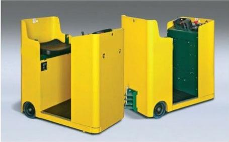
Vehículo de arrastre eléctrico con capacidad de carga de 2.000 kg. De chapa de acero soldado eléctricamente, de estructura rígida para soportar la carga.
