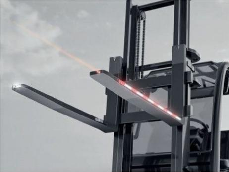
Horquillas con láser incorporado en la punta de la horquilla. El láser proyecta una línea recta marcando el lugar a donde se situarán las horquillas. Resulta de gran ayuda, idóneo para almacenaje en altura y con poca visibilidad.
