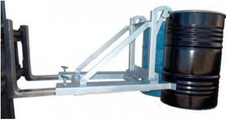
Implemento para carretillas para transportar 2 bidones de 50 hasta 200 L con capacidad de carga hasta 500 Kg cada uno. Equipado con una pinza regulable en altura para adaptarse a todo tipo de bidones.
