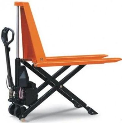
Transpaleta de tijera de traslación manual y elevación eléctrica con capacidad de carga de 1.500 Kg, elevación a 800 mm. Horquillas de 1170mm x 540mm.
