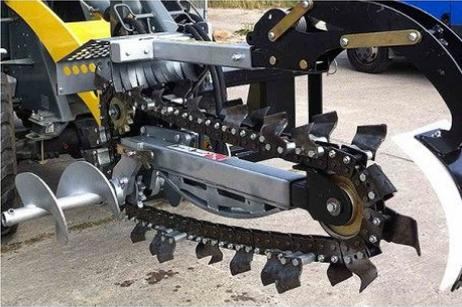
Zanjadoras de alto rendimiento con diferentes tipos de cadena, para la apertura de zanjas en todo tipo de terrenos vegetales, mixtos y compactos, incluso muy duros o con raíces.
