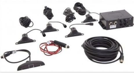
Sensor de Alarma Anti-Colisión para Carretillas Elevadoras. El dispositivo de marcha atrás anti-colisión sensor de alarma montado es un sistema de detección de obstáculos ultrasónico y una ayuda imprescindible para la seguridad. Con hasta 4 sensores que permiten detectar cualquier objeto dentro de 3 metros. Detección de ángulo de 60-80 °
