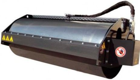
Rodillo compactador con un ancho de 1550mm de tambor y 1820mm de total. El diámetro del tambor es de 610mm y cuenta con una potencia máxima de 3200kg.
