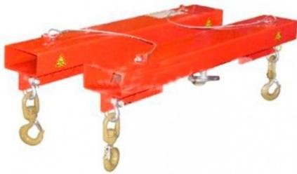
Manipula sin esfuerzos y de forma cien por cien segura, baterías y cargas pesadas con tu carretilla. Gancho que incorpora 4 ganchos basculantes y se instala fácilmente en las horquillas de la carretilla. Levanta de forma estable y segura las baterías hasta 2000 Kg de peso.
