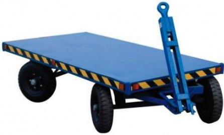
Remolque para transportar hasta 4000Kg.
